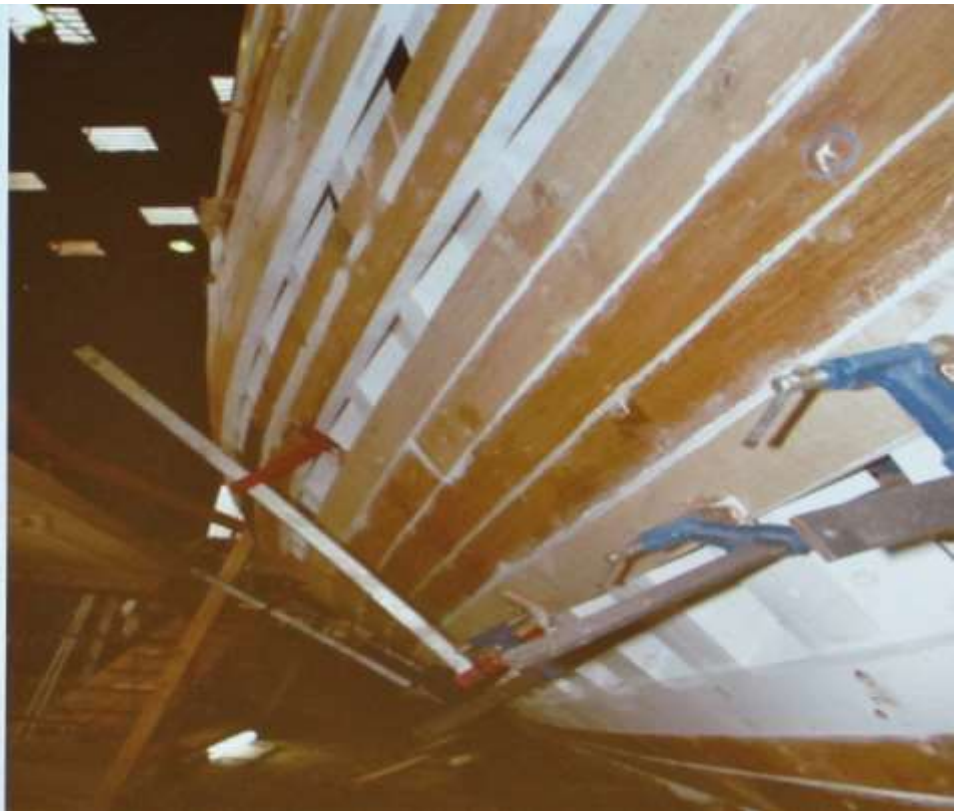
Pose d'un bordé après son préformage à la vapeur
