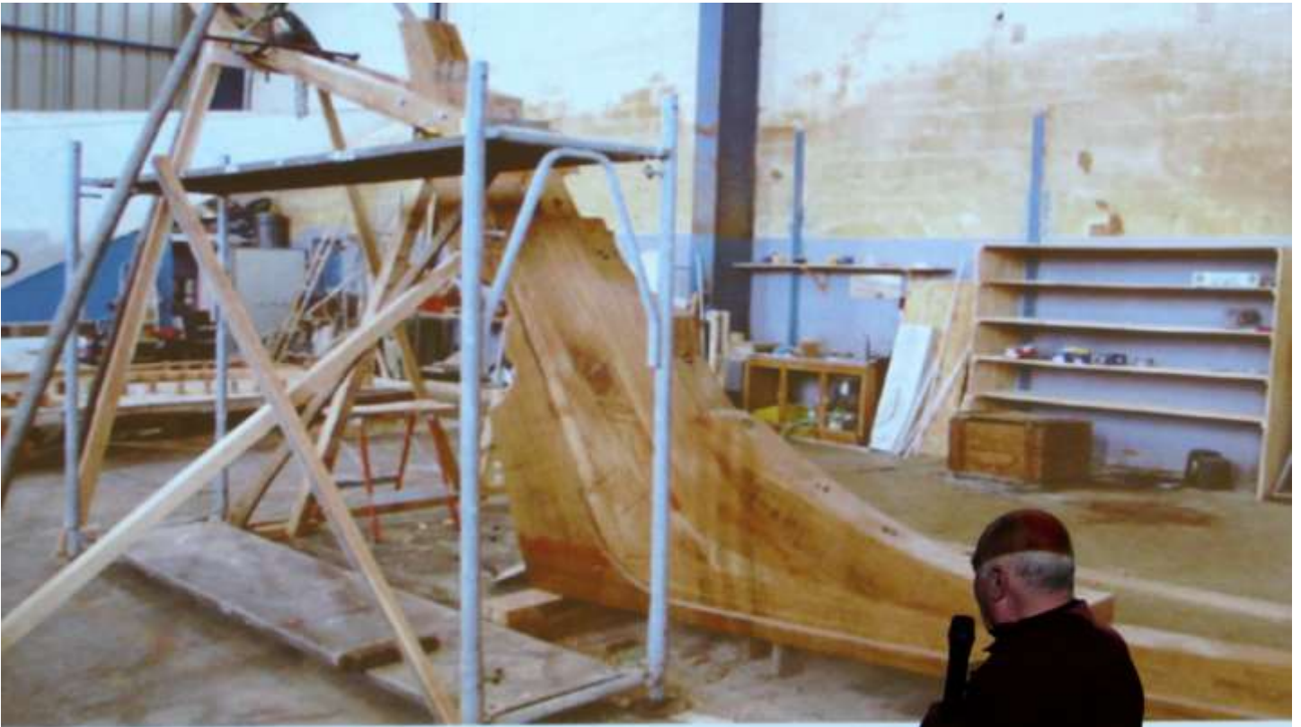
Début de la construction : les MEMBRURES
